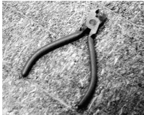
*Si se utilizan los nocks o encoques metálicos, los alicates para la fijación correcta de los mismos es una herramienta imprescindible*
